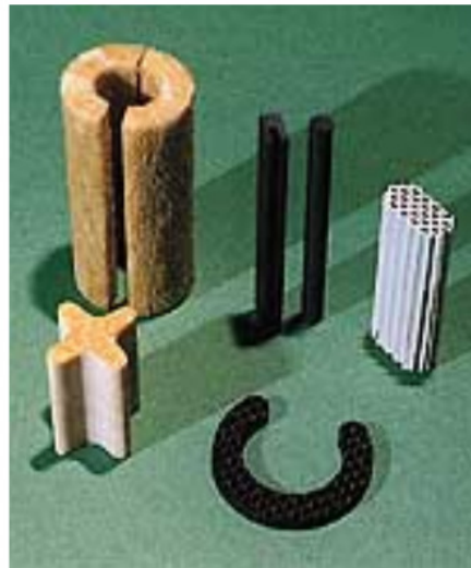
Bild 2: Charakteristische Werkstücke, die auf Seilsägemaschinen qualitätsgerecht hergestellt werden können.
