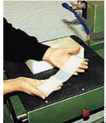
Bild 3: Auch an sehr nachgiebigen Werkstoffen wie Schaumstoff sind mit Seilsägen maßhaltige Schnitte möglich.
