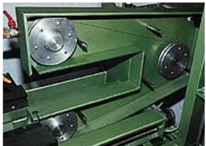
Bild 1: Gemeinsames Merkmal aller Sägemaschinenvarianten ist das endlos ausgebildete Säge-seil, das über drei Rollen läuft, und für das keine separaten Führungsrollen nötig sind.
